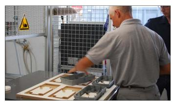
Die Bauteile werden ins Werkzeug eingelegt.
