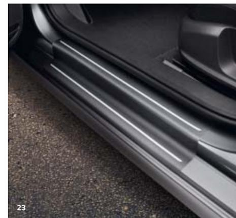
21 Die **Einstiegsleisten** aus Edelstahl mit Jetta Schriftzug setzen ein optisches Highlight am Türschweller und schützen vor Kratzern. **SO**
