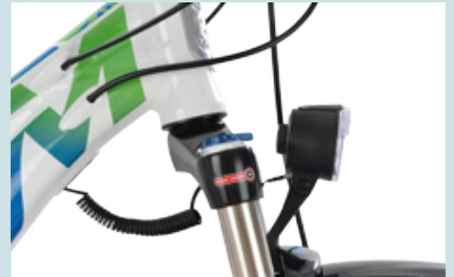
Das SCC Save Cable Concept: aufgeräumte Optik und sicher durch integrierte Kabelführung.
