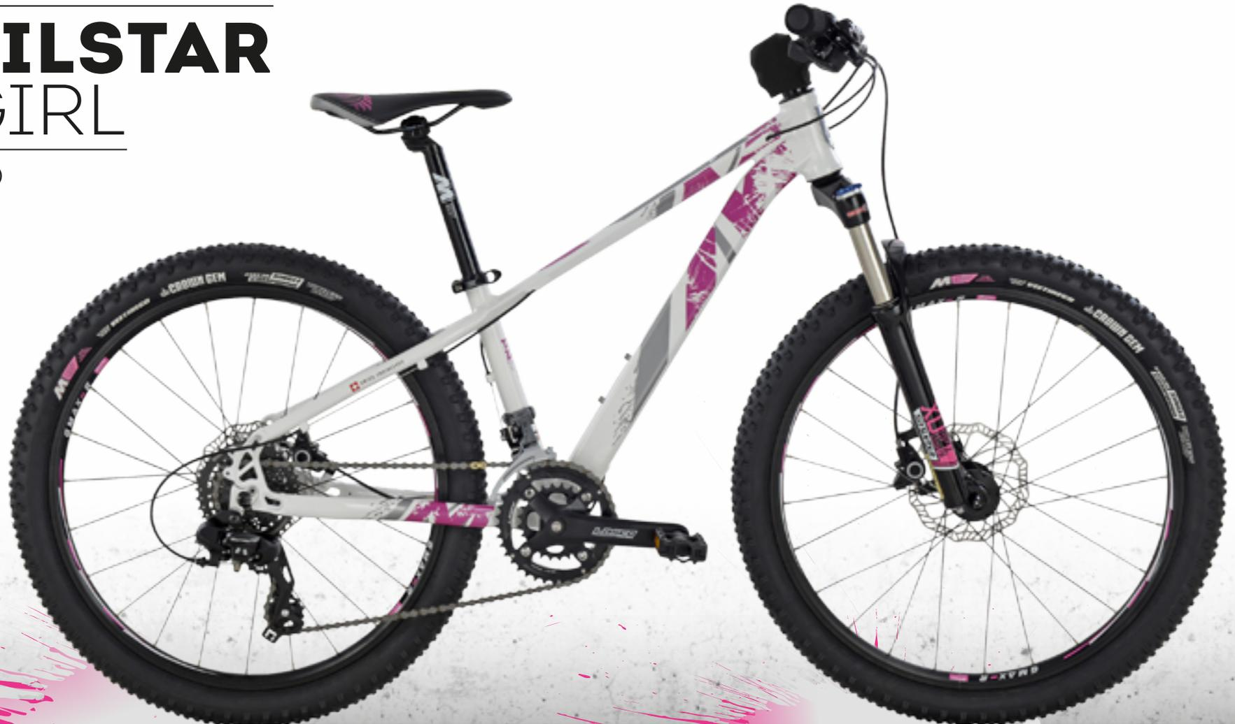
Dank dem ausgesprochen tiefen Gewicht und viel Schrittfreiheit sorgt das **Trailstar 24 Girl** für viel Freude. Der Rahmen ist aus hydrogeformten Aluminium-Rohren gefertigt, die 80mm Federweg der Suntour-Federgabel bringen mehr Komfort und Kontrolle, und dank dem Shimano-Antrieb mit 16 Gängen liegen auch Anstiege drin. Nicht fehlen dürfen hydraulische Scheibenbremsen, die bei jedem Wetter kraftvoll verzögern.
