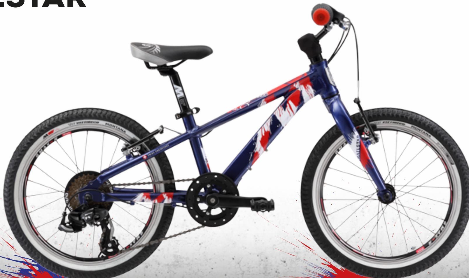
Dem **Trailstar 18** fehlt es an nichts, was velobegeisterte Kinder ab 5 Jahren wollen: Der Rahmen und die Gabel sind aus Aluminium gefertigt und bilden eine leichte Basis. Dank der leichten, faltbaren Reifen lässt sich das Velo einfach beschleunigen, während V-Bremsen für kraftvolle Verzögerung sorgen. Die sechs Gänge werden mit einem Drehgriff geschaltet, der sich auch von kleinen Kinderhänden gut bedienen lässt.
