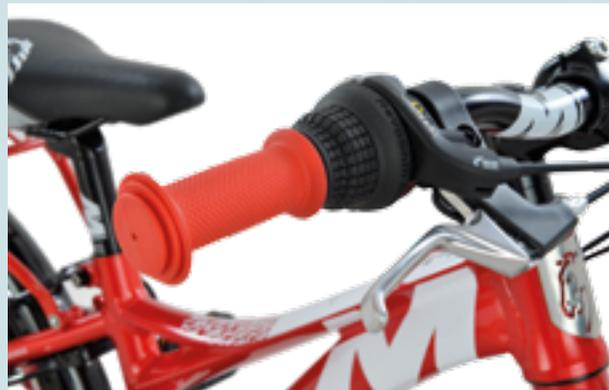
Griffe mit Aufprallschutz und Bremshebel die auf Kinderhände abgestimmt sind.
