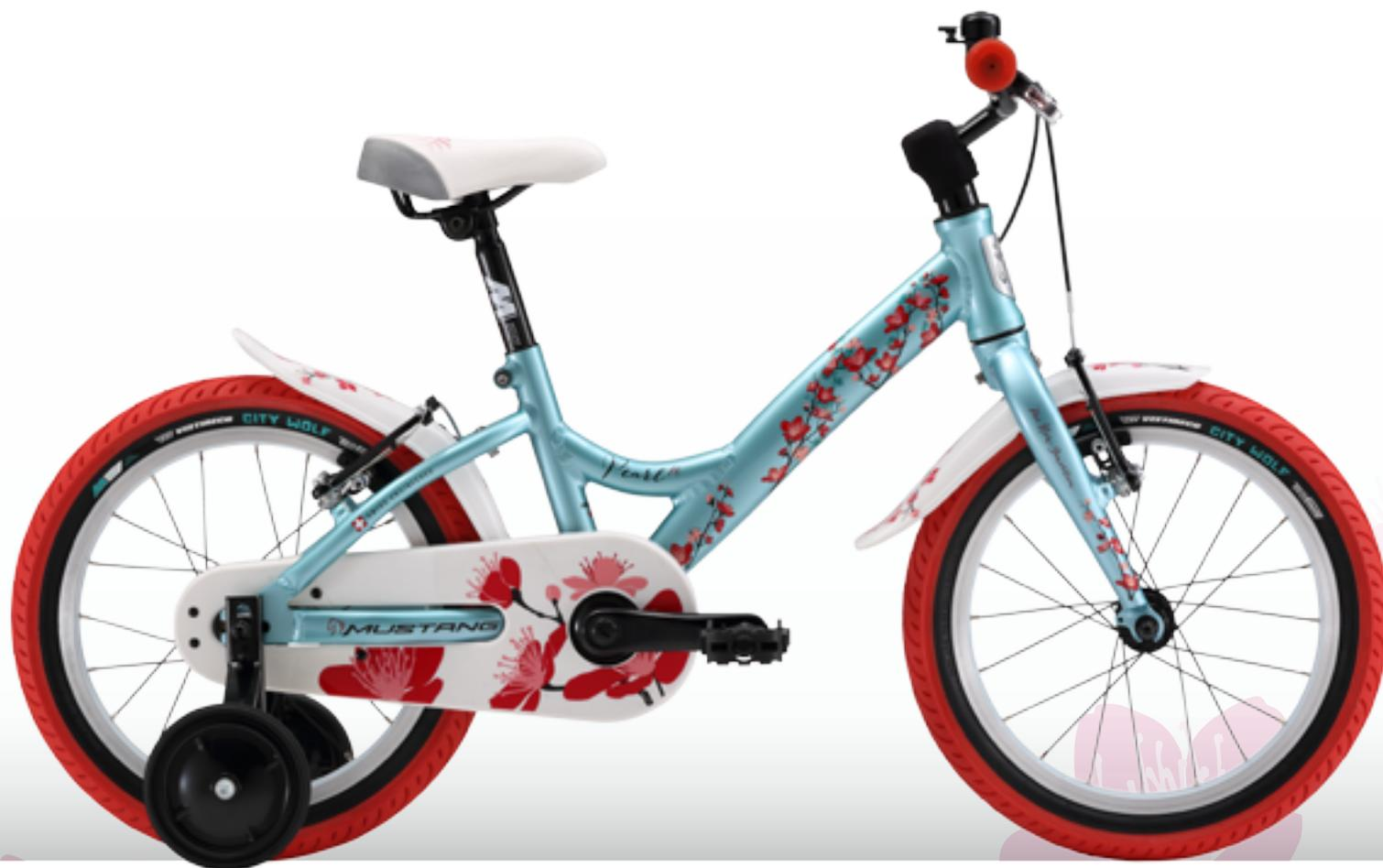
Das **Pearl 16 Girl** kombiniert ein überzeugendes Design mit solider Technik und wichtigen Sicherheitsmerkmalen. Dennoch ist dieses Kinderverlo angenehm leicht, weil der Rahmen und die Gabel aus Aluminium gefertigt sind. Der 1-Gang-Antrieb steckt in einem geschlossenen Kettenkasten und schont so die Kleider, und eine V-Bremse vorne und hinten sorgen für sichere Verzögerung. Natürlich dürfen auch am **Pearl 16 Girl** eine Glocke und Griffe mit integriertem Aufprallschutz nicht fehlen.
