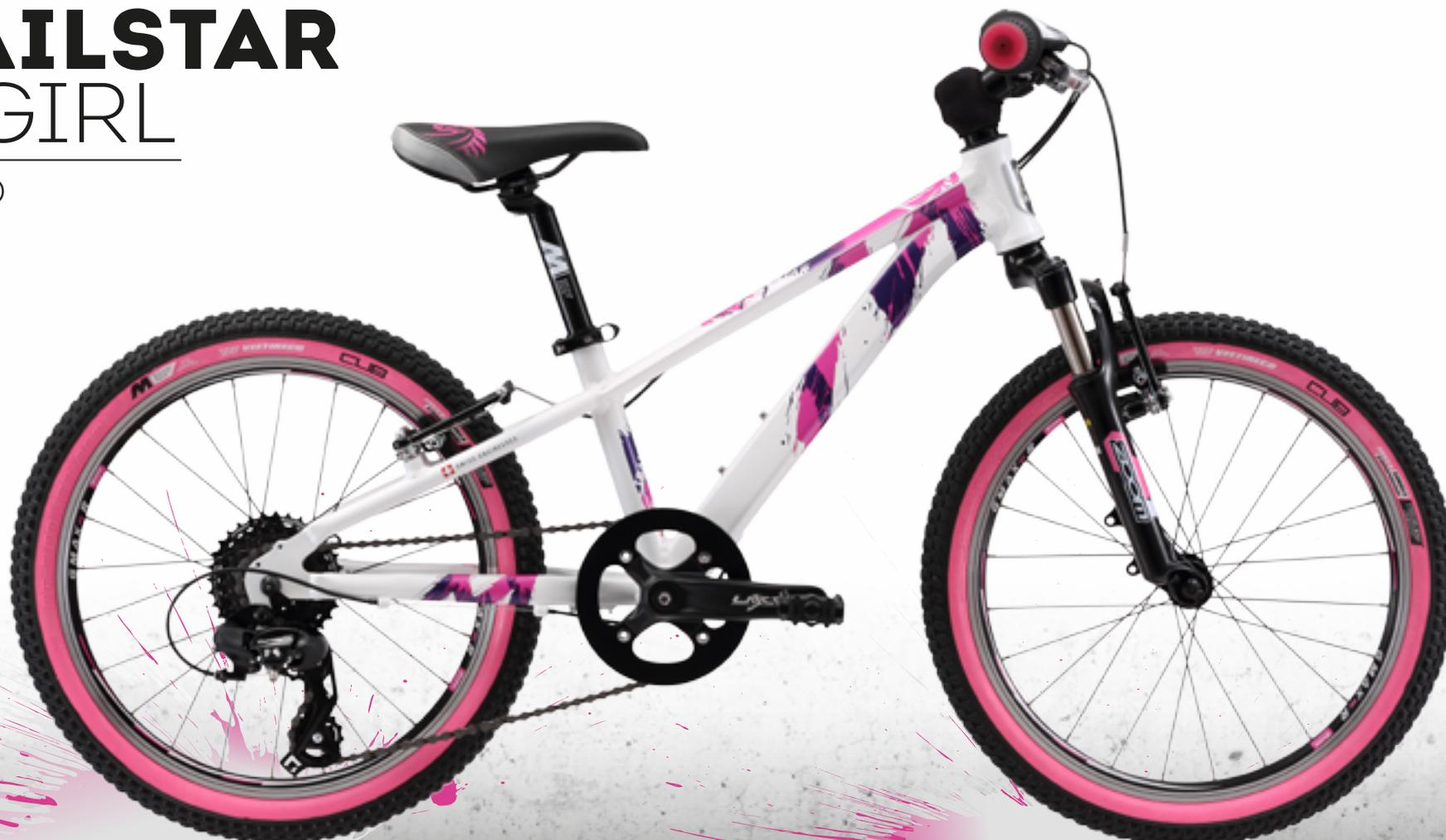
Für Kinder muss ein Velo leicht und einfach zu bedienen sein, damit es Spass macht. Dank dem Aluminium-Rahmen, der wenig wiegt und viel Schrittfreiheit bietet, und dem Antrieb mit 8 Gängen ist das **Trailstar 20 Girl** genau dies. Bei Fahrten abseits befestigter Routen sorgt die Federgabel mit 40mm Federweg für mehr Komfort und Kontrolle, und für kraftvolle Verzögerung verbaut MUSTANG V-Brakes.
