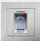
Fingerprint auf Wand Unterputz
