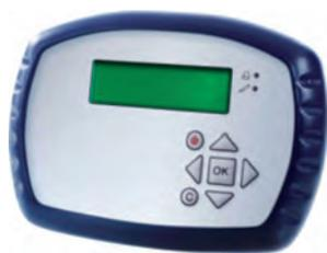
Panneau de commande à affichage LCD "EASY" monté en façade de la centrale **CARMA®** pour réglage horloges, débits, température (gestion proportionnelle du bypass interne, de la batterie chaude pour les versions **BC** ou électrique(s) pour les versions **BE**, surventilation nocturne), contrôle et lecture défaut(s)...
